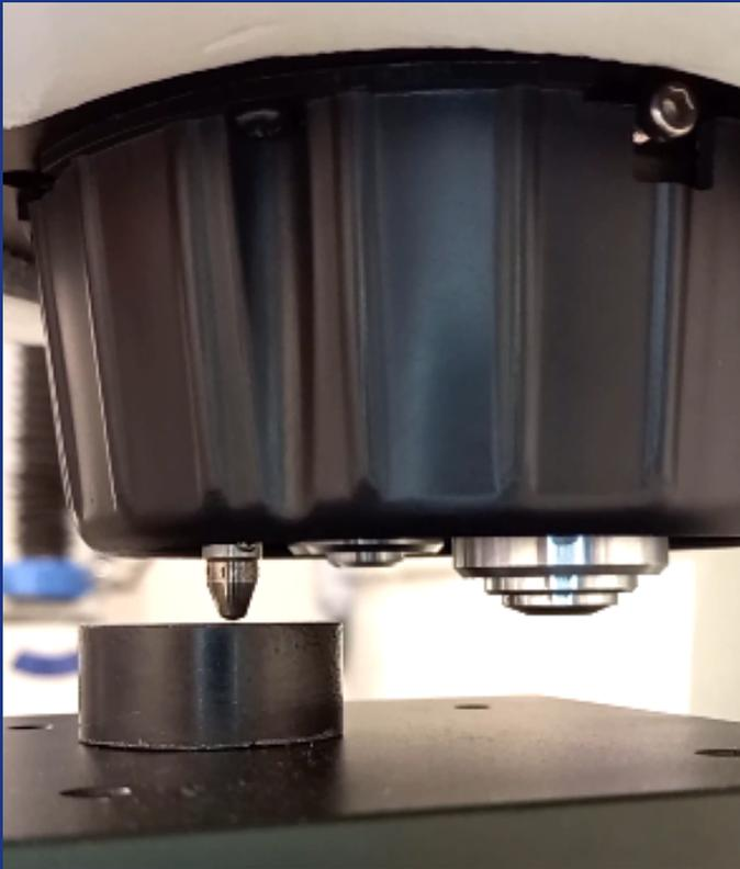
Esse ensaio explora a propriedade de dureza do material, onde podem ser analisados a presença de tratamentos superficiais e, também, corroboram com a identificação da microestrutura.
